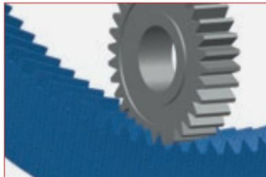
*Vom Finishing zur Komplettbearbeitung: Dank fortschrittlicher Werkzeuge und moderner Anlagentechnik ist Power-Honen zum einstufigen Fertigungsverfahren geworden.*
